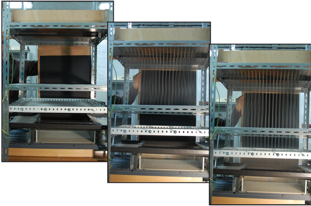
FIG. 3.5 – Le remplissage : une fois le tamis traversé, l'écoulement devient diffus, remplissant de façon homogène la boîte.
