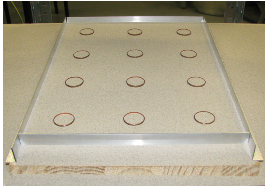
FIG. 3.6 – Réseau de capsules placé sous la semeuse. La mesure du poids du sable dans le volume connu des capsules permet de déterminer la densité du sable.
